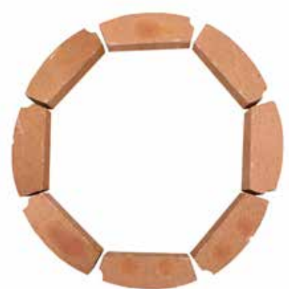
PÖNTTÖUUNIN TIILET SISÄLTÄVÄT PORSLIINIMURSKAA.
