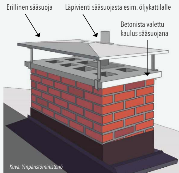
Kuva 12. Erillisellä sääsuojalla varustettu teräksinen piippuhattu, joka suositellaan tehtäväksi kiinteää polttoainetta käyttävien tulisijojen savupiipuille.
