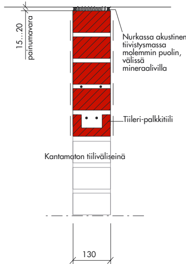
NRT-tiiliväliseinän oviaukon ylitys
